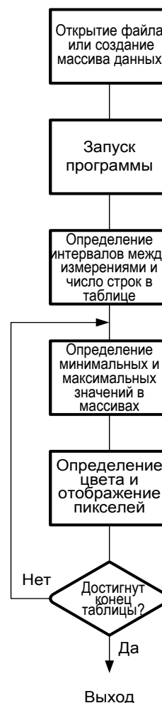
Рис. 5 – Блок-схема алгоритма работы режима "Load"
