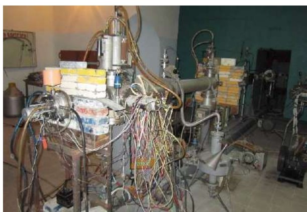
Рис. 5 – Экспериментальный комплекс высокотемпературных коррозионных и трибологических испытаний углеродных материалов: электропровод ускорителя ELLAS с вакуумной системой, системами настройки и управления пучком, на конечном узле которого смонтирована камера для окисления и истиранию образцов углеродных материалов
