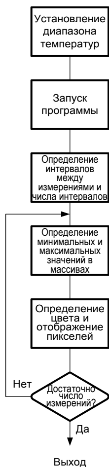
Рис. 4 – Блок-схема алгоритма работы режима эмуляции
