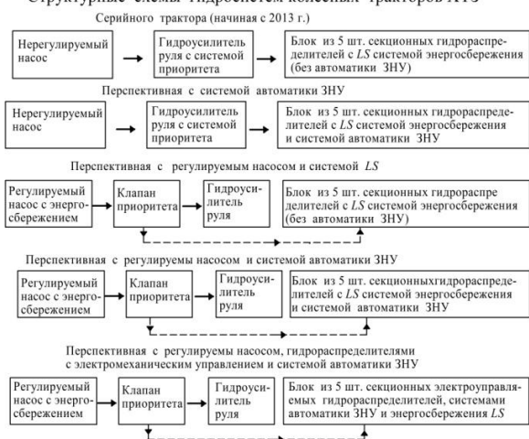
Рис. 1. Структурные схемы объемных гидроприводов рулевого управления и навесного устройства колесных тракторов с учетом их исторического развития
