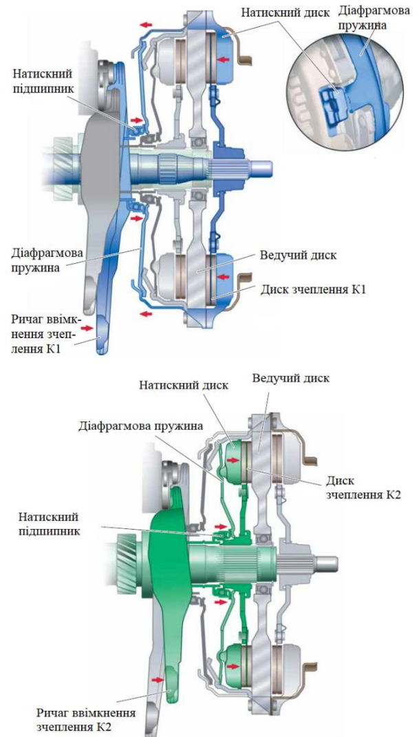
Рис. 6. Схема роботи сухих зчеплень K1 та K2
