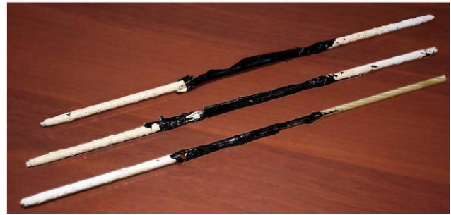
Рис. 5 – Образцы арматуры композитной после экспозиции в расплаве битума до испытания на механическую прочность. Концы образцов были защищены от воздействия битумного расплава
