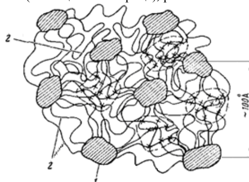
Рис. 2 – Модель микродоменной структуры в полиуретановой матрице:
