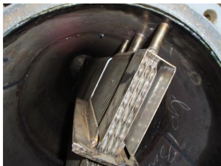
Рис. 6– Попарно сваренные пластины разборной греющей камеры
