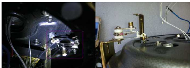
Рис. 4. Розташування датчика тиску у мультиварці
