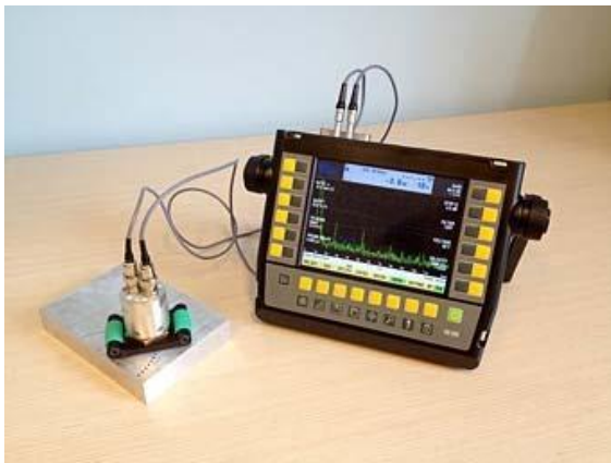
Рис. 2 – Дефектоскоп з електромагнітно-акустичним перетворювачем
