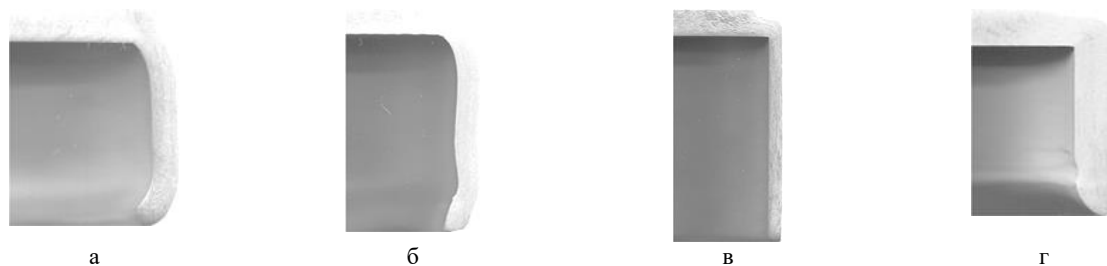
Рис. 6 – Меридіональні перерізи отриманих порожнистих деталей
