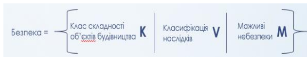
Рис. 1 – Формалізована модель-схема управління безпекою на стадії планування проектів з масовим перебуванням людей з врахуванням категорії складності
