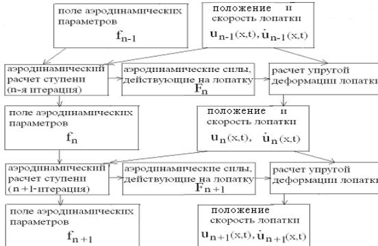
Рис.5 – Блок-схема расчета  $n$ -ой итерации аэроупругой модели
