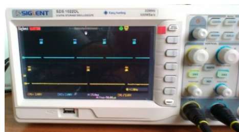
Рис. 3 – Осциллограммы серии импульсов на выходе микроконтроллера
