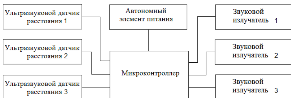
Рис. 1 – Структурная схема системы панорамного ультразвукового обнаружения препятствий для слепых
