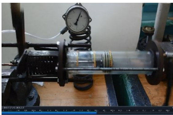
Фото 3. Положение поршня, при котором явно выражено изменение цвета воздушной среды перед поршнем, что свидетельствует о фазовых преобразованиях
