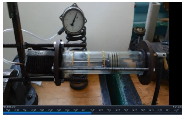
Фото 1. Положение поршня в начале эксперимента. В области перед поршнем избыточное давление 3 бара, пружина сжата
