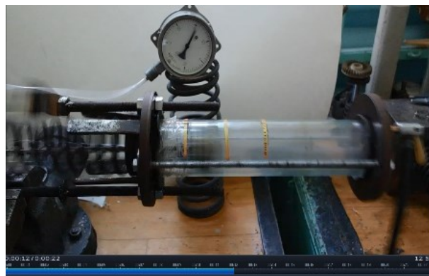
Фото 4. Положение поршня, при котором наблюдается разрежение в пространстве перед поршнем
