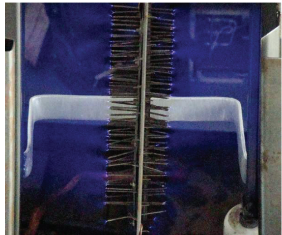
Рисунок 2 – Об'ємний розряд, який займає весь об'єм електродної системи
