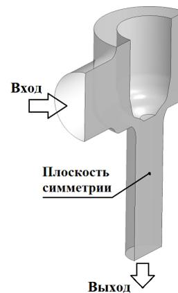
Рис. 2 – Геометрическая модель клапана
