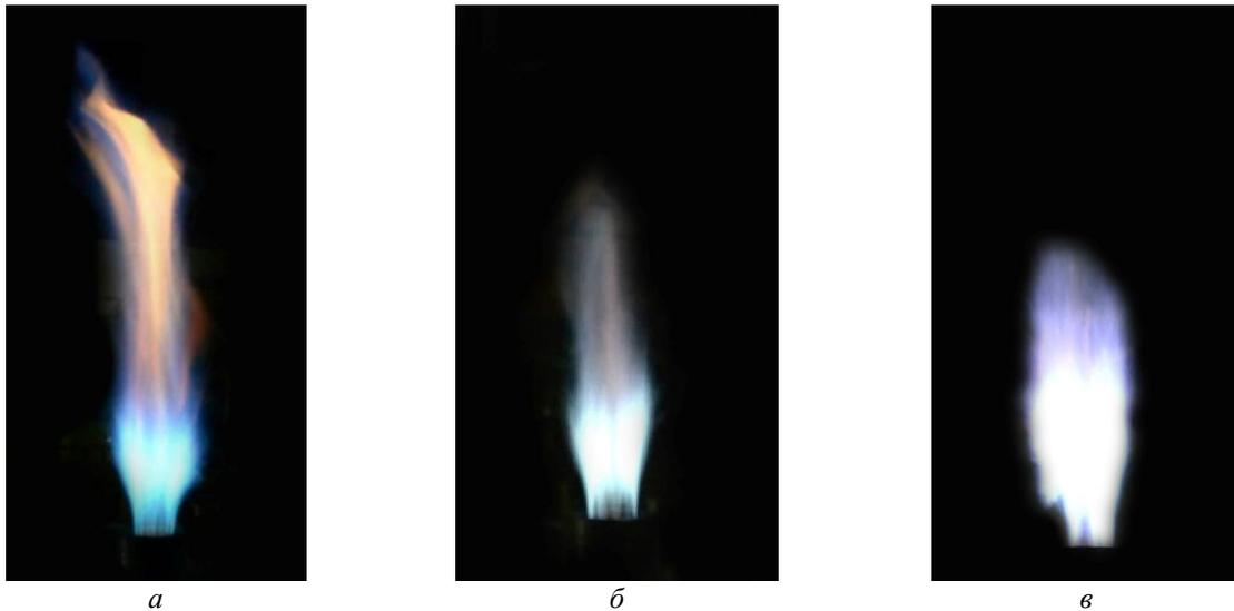
Рис. 3 – Структура відкритого факелу в циліндричній СНС для різних значень кутового кроку розташування паливних отворів  $\varphi$ :  $a - 22,5^\circ$ ;  $b - 36,0^\circ$ ;  $c - 45,0^\circ$ ; при  $d = 2$  мм,  $L_1 = 13,5$  мм
