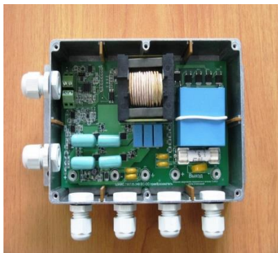
Рис. 10 - Розроблений і виготовлений DC-DC перетворювач
