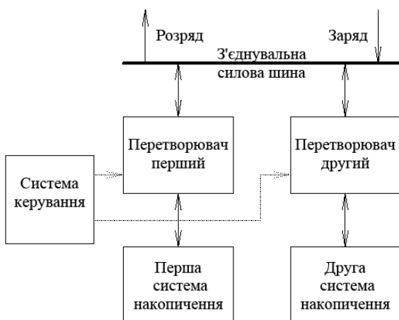
Рис. 2 – Базова структура системи накопичення електроенергії [14]
