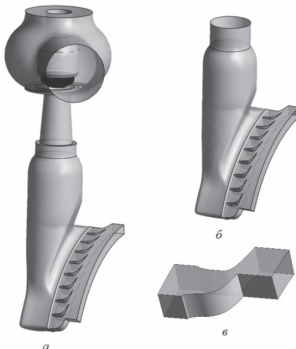
Рис. 1 – Модель проточной части отсека: а – РК-ВП-СС; б – ВП-СС; в – СС
