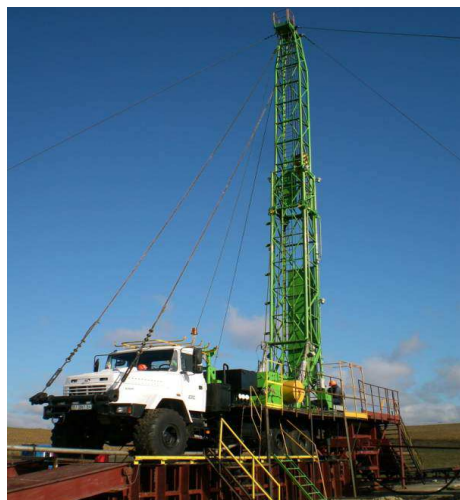
Рис. 1 – Автомобіль для ремонту нафтогазових свердловин.
