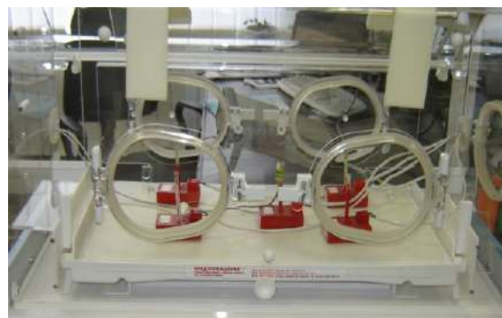
Рис. 1 – Розташування датчиків усередині інкубатора
