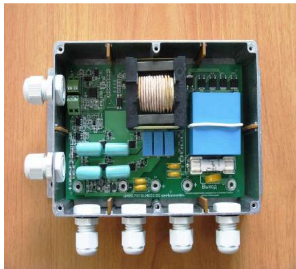
Рис. 20 - Розроблений і виготовлений DC-DC перетворювач
