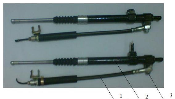
Рис. 4 – Загальний вигляд циліндрів управління в зборі:
