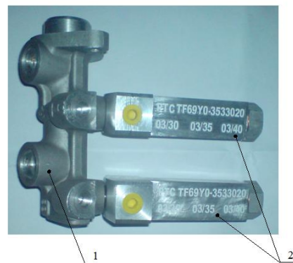
Рис. 3 – Загальний вигляд регуляторів гальмівних сил в зборі з головним гальмівним циліндром:
