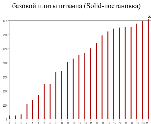
Рис. 11 – Спектр собственных частот колебаний блока штампа (Shell-конструктивы)
