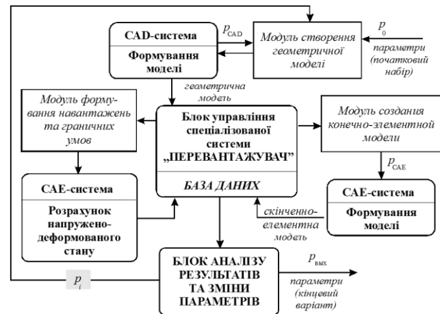
Рис. 3 – Схема роботи спеціалізованої системи аналізу НДС і синтезу параметрів мостового перевантажувача
