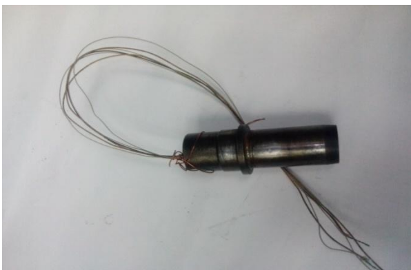
Рис. 1 – Препарована для термометрії серійна напрямна втулка
