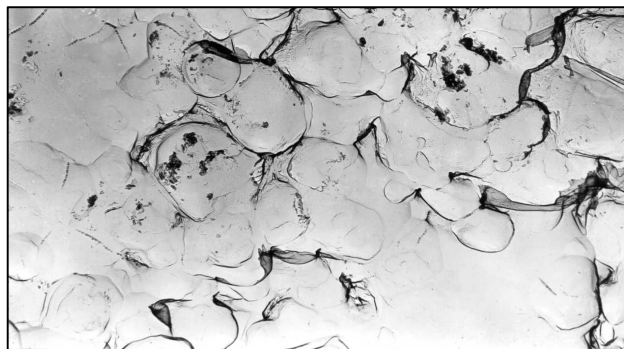
Рис. 3 – Мікроструктура композиційного матеріалу складу Ca_{10}(PO_4)_6(OH)_2/ZrO_2 , при вмісті 20 мас. % ZrO_2 тетрагональної модифікації, частково стабілізованого Y_2O_3 , після термообробки при 1300 °C ( \times 18000 ).
