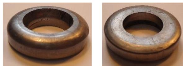
Рис. 8. – Детали типа колец, получаемые при радиальном выдавливании с внедрением пуансона в тело фланца
