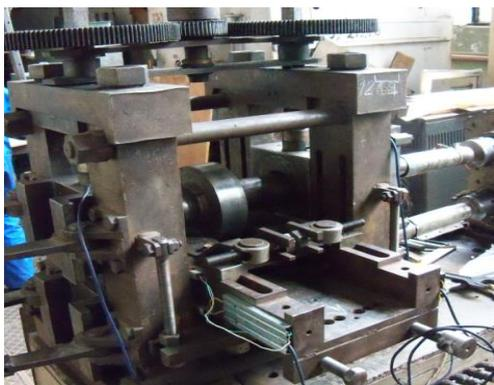
Рис. 3 – Робочий вид кліті з встановленою касетою
