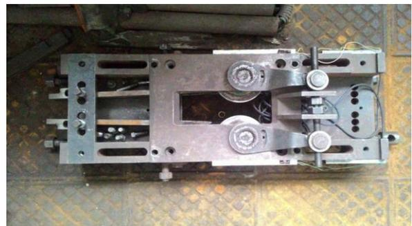
Рис. 2 – Касета з неприводними валками
