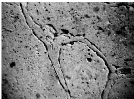
Рис. 1 – Структура щільного шамотного ячеїсто заповненого вогнетрива
