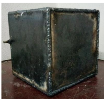
Рис. 4. Зовнішній вигляд випробувальної камери без покриття та з нанесеним теплозахисним покриттям
