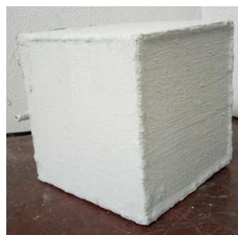
Рис. 4. Зовнішній вигляд випробувальної камери без покриття та з нанесеним теплозахисним покриттям
