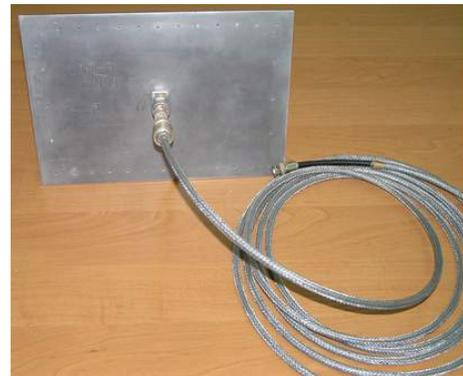
Рисунок 9 – СПЕФВ-ЕК с кабельной линией передачи информации
