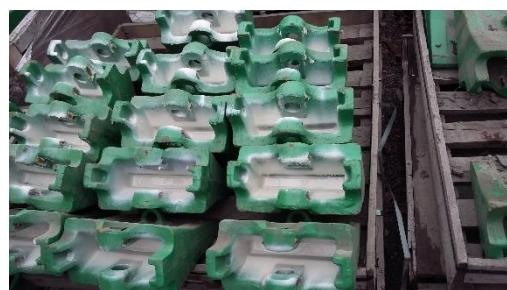
Рис. 1 – Коронки зубьев ковшей экскаватора
