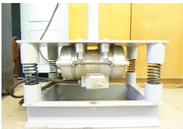
Рис. 2 – Общий вид опытного вибростола для исследования процесса предварительного уплотнения порошковых масс
