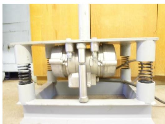
Рис. 5 – Общий вид опытного образца вибростола с жестко-упругими ограничителями
