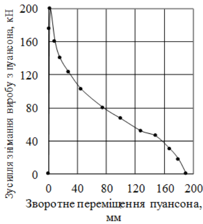
Рис. 8 – Залежність зусилля змінання виробу від зворотного переміщення пуансона
