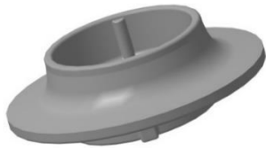
Рис. 2 – Тривимірна геометрична модель штампівки
