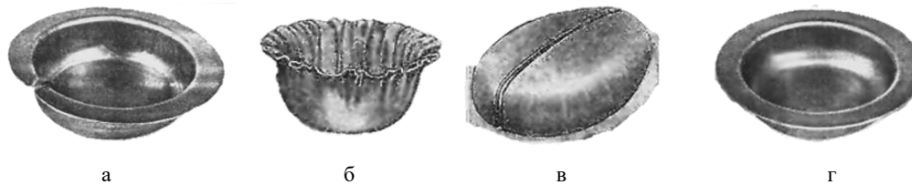
Рис. 4 – Деталі, отримані при різних рівнях зусилля притискування заготовки: а – 1,96 МПа; б – 0,98 МПа; в – 2,45 МПа; г – 1,47 МПа
