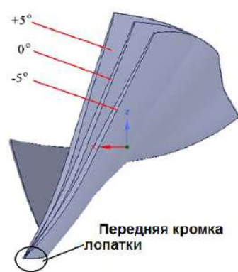
Рис. 5 - Схема поворота кромочного сечения лопатки
