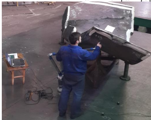
Рис.12 – Контрольная разметка лопасти под механическую обработку
