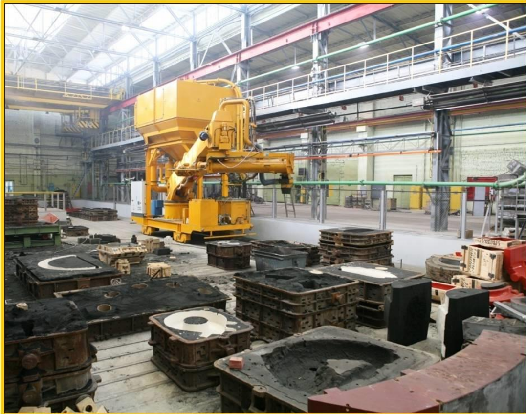
Рис.3 – Новый мобильный смеситель ф. IMF (Италия)
