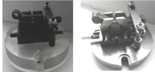
Рис. 2 – Запропонований ВП для обробки важелів: а - функціональна модель; б – дослідний зразок
