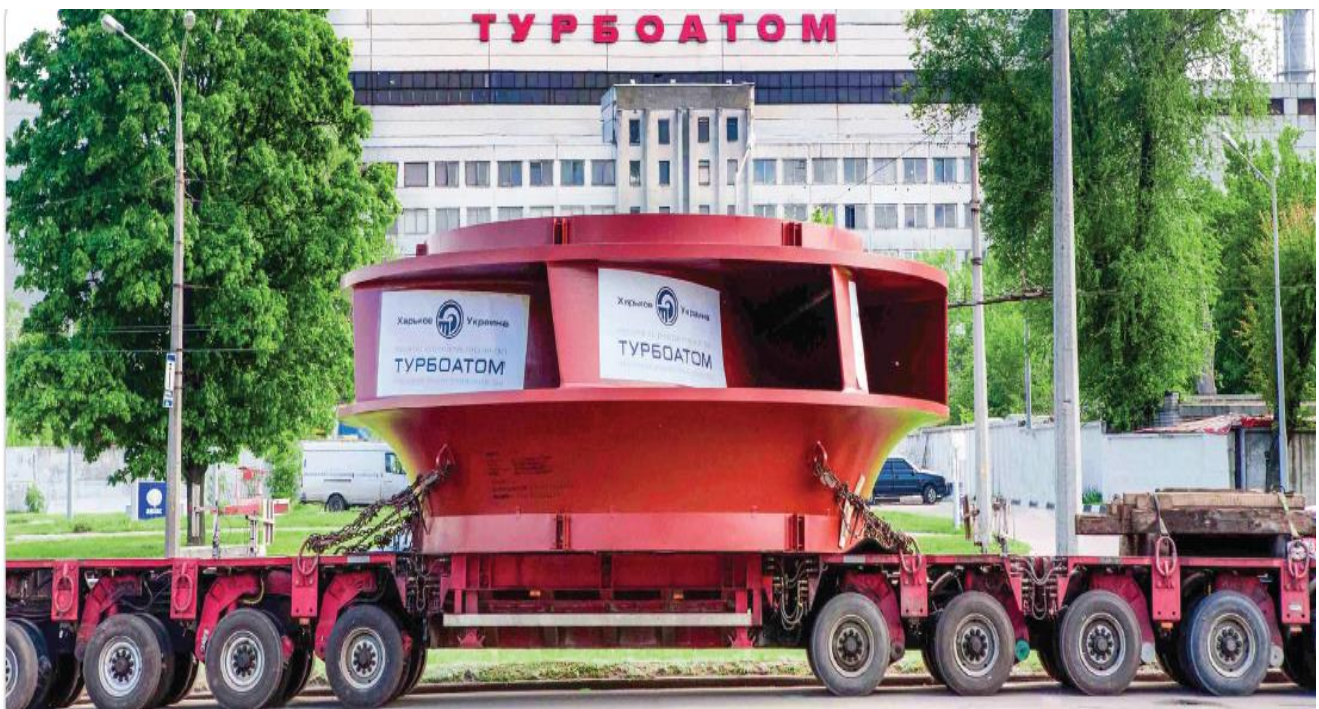
Рис.13 – Отгрузка рабочего колеса \varnothing = 7,3\text{м} , m=120\text{т} . спецтранспортом
