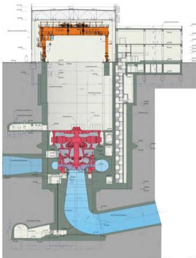
Рис.1 – Разрез по агрегату Днестровской ГАЭС
