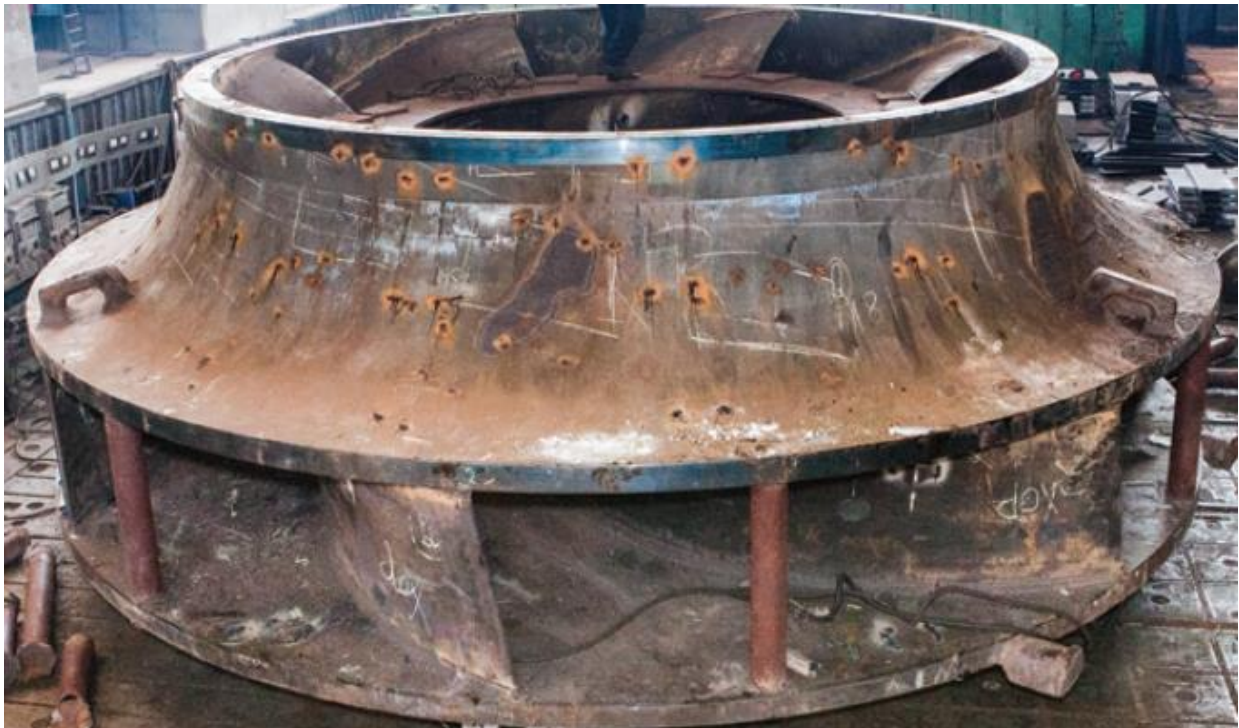
Рис. 6 – Рабочее колесо Днестровской ГАЭС после сварки
