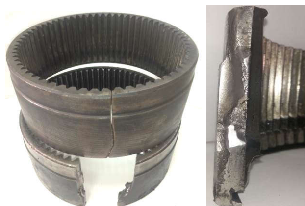
Рис. 1 – Фото характерных разрушений образцов эпицикла ПКР Raba 118/77: а – усталостные трещины в ободу; б – поверхность разрушения (гладкие участки – результат циклического трения берегов трещины при вращении сателлитов, крупнозернистые – зоны долома)
