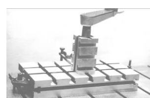
Рис. 12 – Компоновка УСП с фиксацией опоры обычной призматической шпонкой
