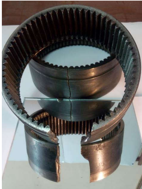
Рис. 1 – Фото утомних руйнувань епіциклів ПКР типу Raba 118.77
