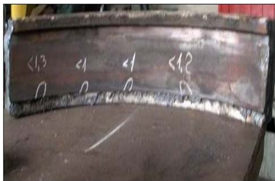
Рис. 5 – Тріщини в області крайки виточки під бандажне кільце
