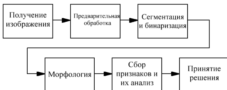
Рис. 3 – Упрощенная схема распознавания образов на изображении
