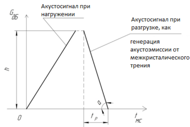
Рис. 2 – Диаграмма акустосигнала при исследовании образца
