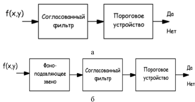
Рис. 7 – Структуры оптимальных обнаружителей изображения объекта на фоне помех: а – с равномерным энергетическим спектром, б – с энергетическим спектром произвольной формы
