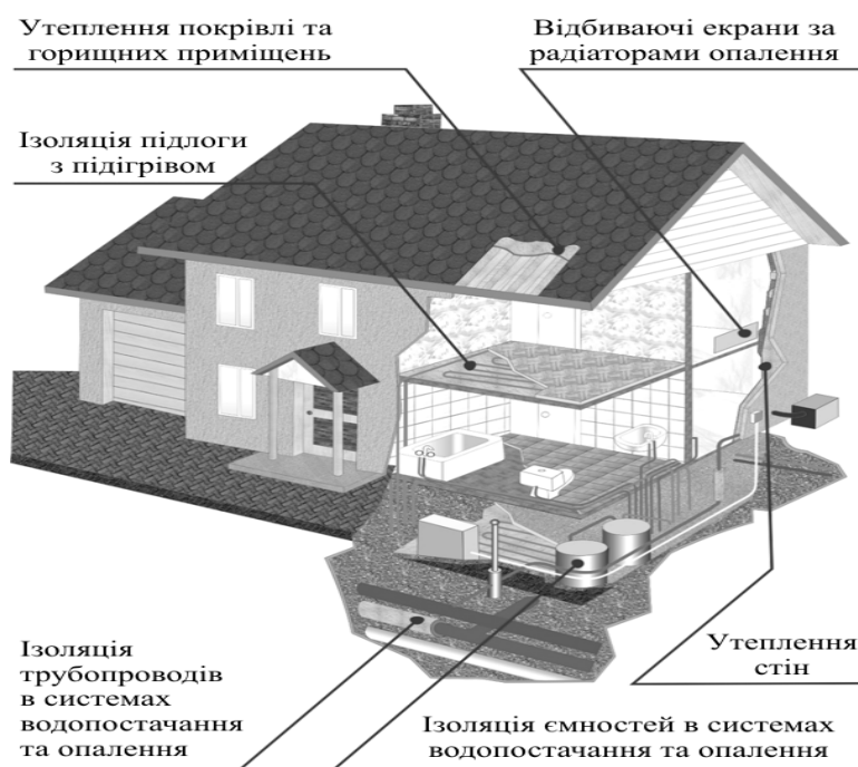
Рис. 1. Деякі різновиди виробів з вторинного спіненого поліетилену на об'єктах будівництва
