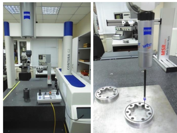
Рис. 9 – Вимірювання параметрів цівкового колеса на координатно-вимірювальній машині Contura G2 (Carl Zeiss)
