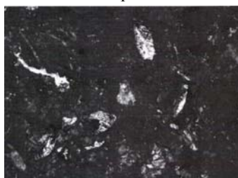
Рис. 2 – Микроструктура: 1 – фторопласта Ф4; 2, 3, 4 – графитопластов на его основе (×100)
