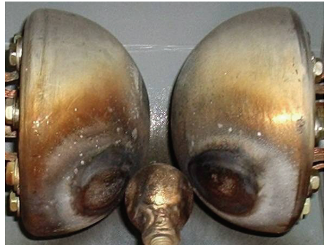
Рисунок 3 – Укрупненный вид электродной системы высоковольтного сильноточного воздушного коммутатора каскадного типа с двумя массивными основными полусферическими электродами и управляющим сферическим электродом \varnothing 30 мм из стали марки Ст.3 на номинальное напряжение \pm 50 кВ и импульсный микросекундный ток амплитудой I_m до \pm 300 кА (после однократного воздействия на ее стальные электроды в разрядной цепи ВЭФУ с мощным ЕНЭ импульсного затухающего синусоидального тока частотой 4,9 кГц и амплитудой I_{ms} = -202 кА; J_a = 2,12 \cdot 10^6 Дж/Ом; опытное значение радиуса канала искры между катодом и анодом СВК l_c = 13,5 мм; R_e = 61,5 мм)
