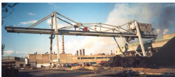
Рис. 29 – Спроектированный перегружатель ПМГ-20
