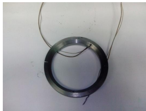
Рис.2 - Препароване сидло випускного клапана. На рис.3(а,б,в) показана динаміка зміни температури охолоджуваного сидла (точка 1) при підведенні охолоджувача в межах тестових температур.
