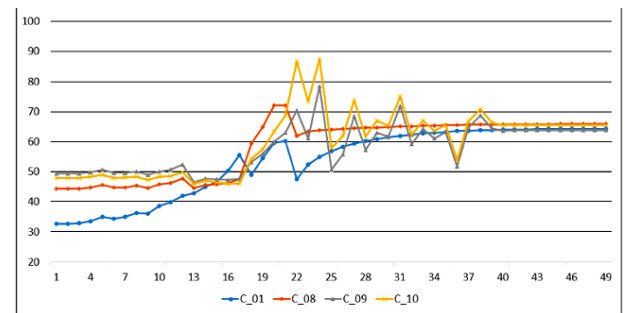
Рис. 37 – Еквівалентні напруження за Мізесом (МПа), шлях 2
