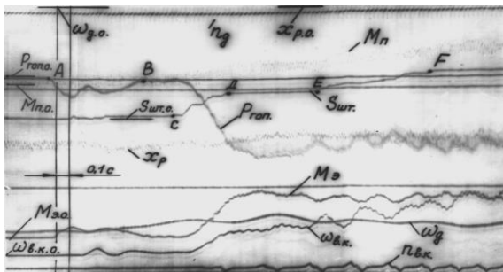
Рис. 2 – Осциллограмма процесса разгона агрегата при постоянной настройке регулятора топливного насоса
