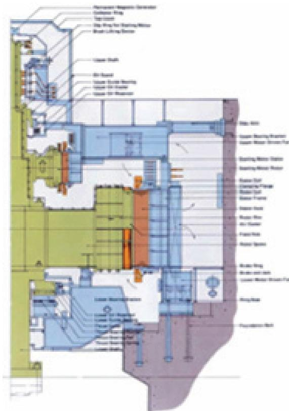
Рис. 1 – Вертикальний гідрогенератор
