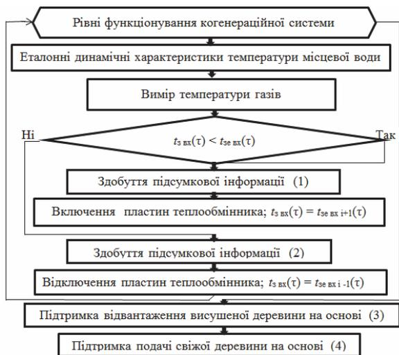
Рис. 5 – Структурна схема підтримки температури місцевої води на рівні прийняття рішень, де  $t_{3 вх}$ ,  $t_{3е вх}$  – функціональна та еталонна температура газів на вході в теплообмінник підігріву місцевої води, K;  $i$  – число рівнів функціонування;  $\tau$  – час, с
