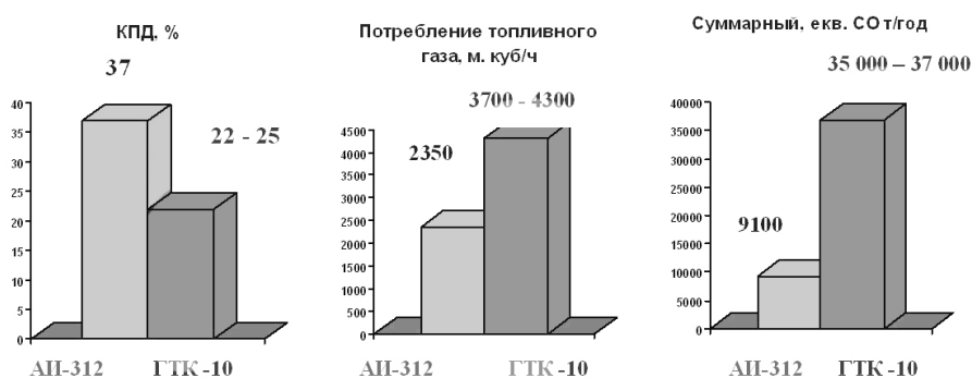
Рис. 4 – Сравнительный анализ характеристик АИ-312 и ГТК-10
