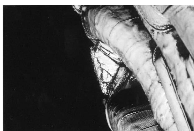
Рис. 3 – Розтріскування ізоляції
