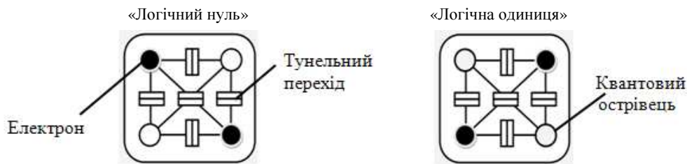
Рис. 5 – Базова комірка в двох можливих логічних станах.
