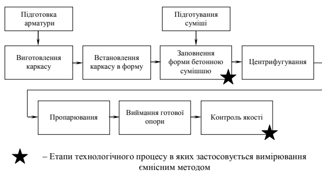
Рис. 5 – Схема технологічного процесу виготовлення опор для ЛЕП із елементами вимірювання щільності бетону
