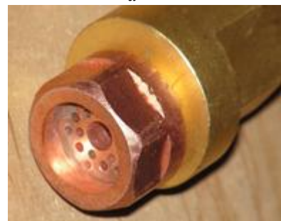
Рис. 3 – Головка резака РЗ-ФЛЦ-ВС в сборе: а – конструкция головки резака; б – внешний вид
