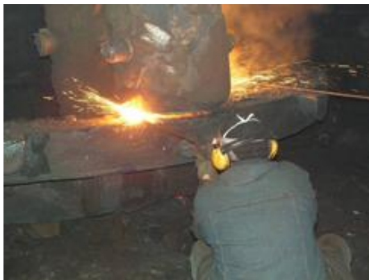
Рис. 9 – Кислородная резка прибыли ф900 мм литья из стали 20Л
