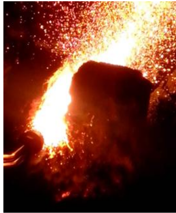
Рис. 6 – Процесс кислородной резки образца толщиной 350 мм из высоколегированной стали 40X9C2Л резаком РЗ-ФЛЦ-ВС.
