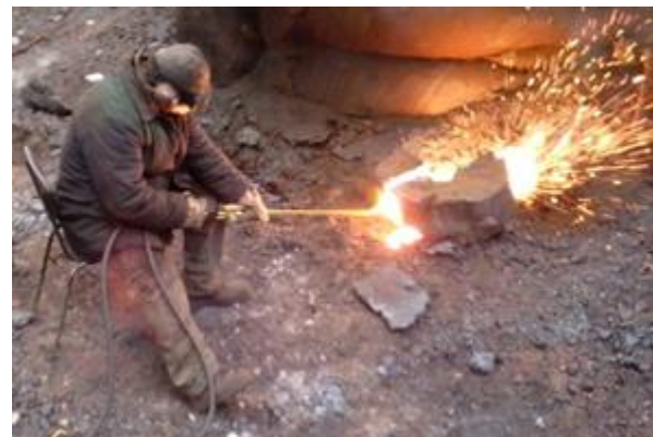
Рис. 7 – Кислородная резка образца толщиной 400 мм из стали 08X18H9Т резаком РЗ-ФЛЦ-ВС, мундштук №3
