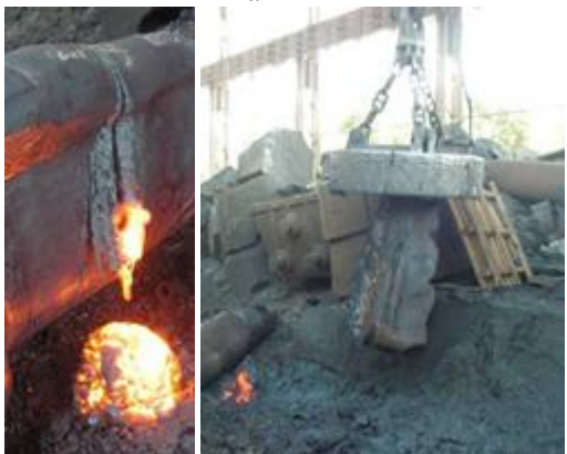
Рис. 8 – Кислородная резка поковки из стали 38Х1МФА толщиной по линии реза 850 мм
