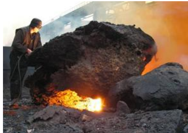
Рис. 10 – Разделка крупной скрапины на габаритные куски газокислородным резакор РЗ-ФЛЦ-ВС.
