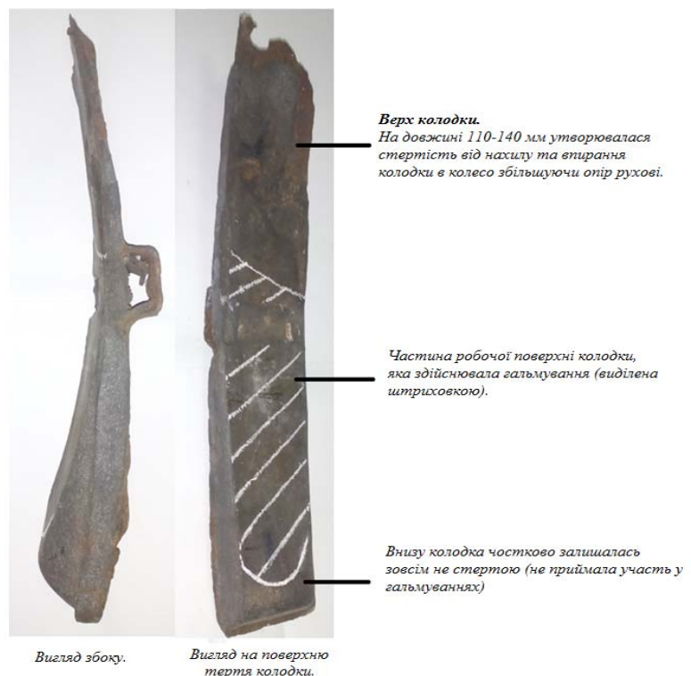
Рис. 3 – Типовий зразок спотворено зношеної гальмівної колодки
