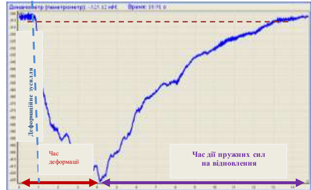
Рис. 3 – Деформаційна діаграма осьового розтягу зразків: повздожній зріз м'язів
