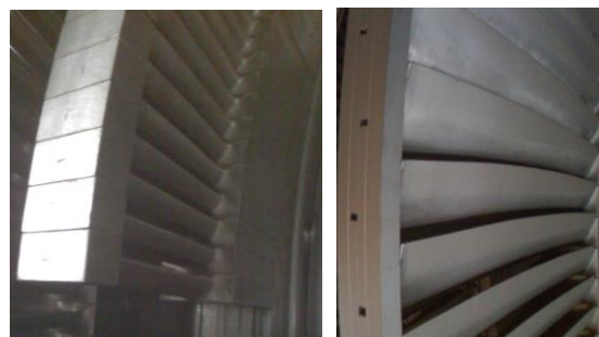
Рис. 3 – Фотографії етапів зборки лопаток
