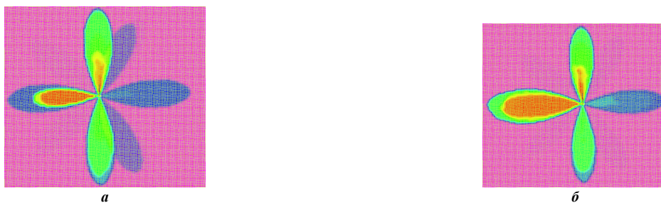
Рис. 5 – Діаграми небезпечності точок на карті для ЛБМ, в залежності від розподілу товщин бронелистів: а – монотонщина; б – реальний розподіл
