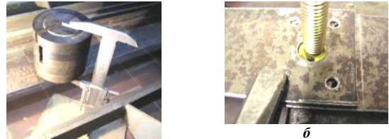
Рис. 19 – Дослідження системи: а – навантаження мірними вантажами; б – вибраний зазор; в – компоновка болтового з'єднання
