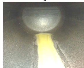
Рис. 9 – Разгрузка серы из вагона: а – подключение сливной арматуры; б – оценка полноты разгрузки вагона
