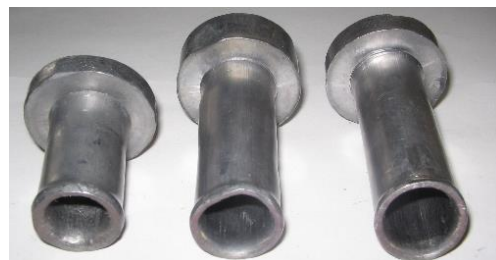
Рис. 6. – Детали, полученные радиально-прямым выдавливанием с обжатием
