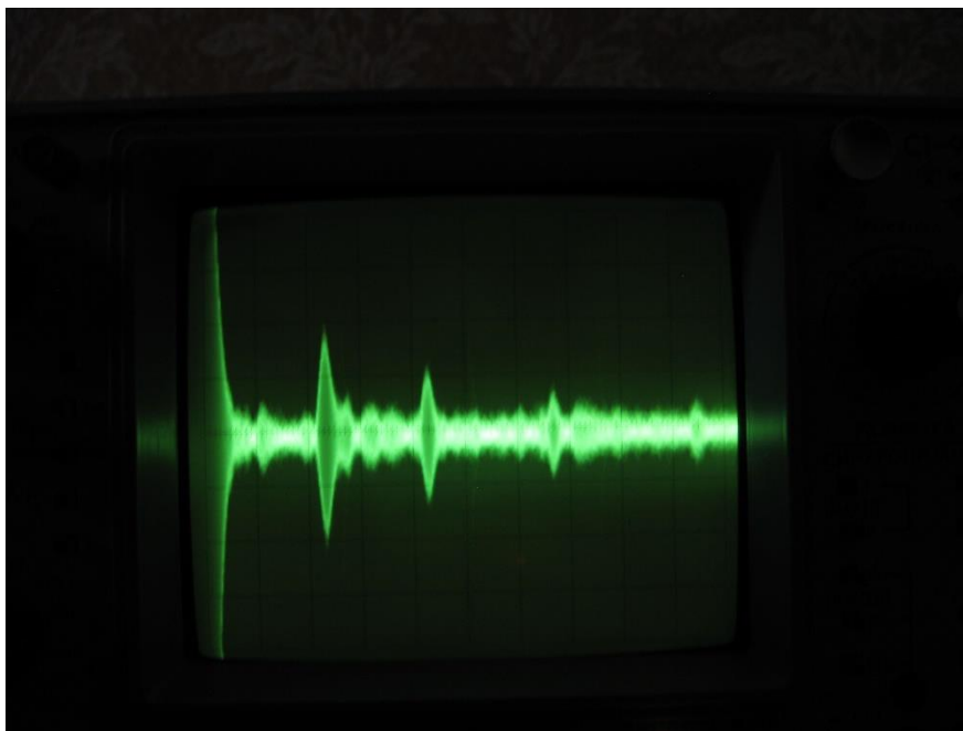
Рис. 6 – Временная развертка на экране осциллографа при обнаружении дефекта на поверхности торца изделия
