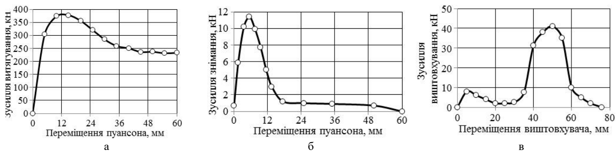
Рис. 9 – Силкові параметри процесу витягування з потоншенням: а – залежність зусилля витягування від переміщення пуансону, б – залежність зусилля від переміщення пуансону при зворотному ході пуансону, в – залежність зусилля виштовхування з матриці від переміщення виштовхувача
