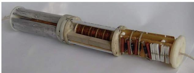
Рисунок 8 – Макет зарядного блока
