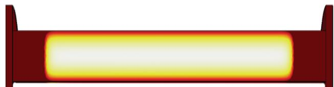
Рисунок 13 – Распределение температурного поля шунта
