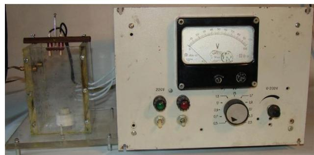
Рисунок 2 – Технологический узел и электроразрядный контур в металлическом корпусе установки СВС
