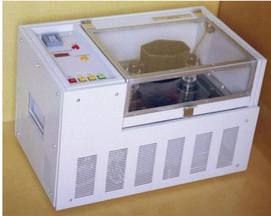
Рисунок 2 – Установка для испытания масла УИМ-90
