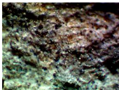
Рис. 8 – Скол образца цементного камня с добавкой НКФН (28 суток): а, б, в – различные участки поверхности скола.
