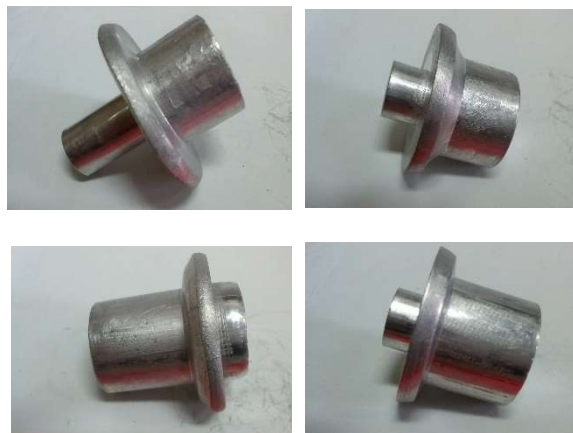
Рис. 5 – Детали, полученные комбинированным выдавливанием
