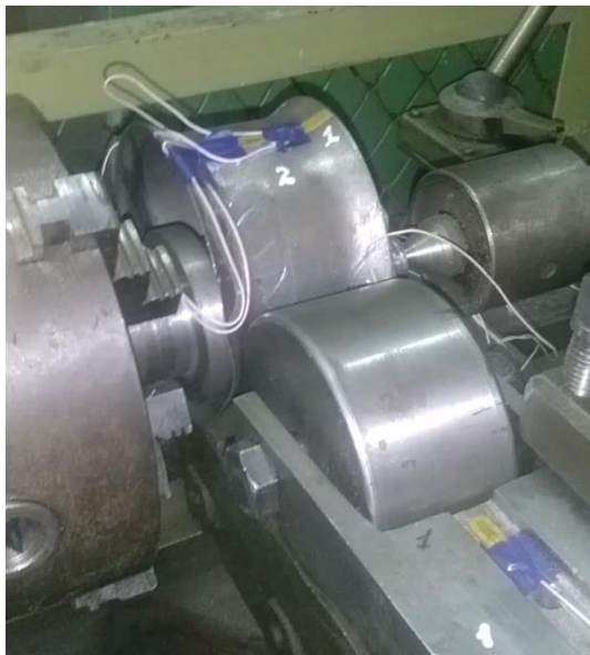
Рис. 1 – Первый переход радиально-ротационного профилирования обода колеса W8x16 (коническая заготовка)
