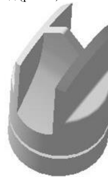
Рис. 7 – ЕІ для отримання “Н” – подібного отвору
