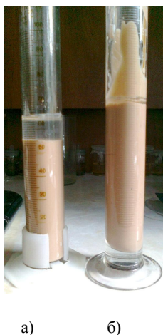
Рис. 6. Седиментаційна стійкість 10 % бентоніту з додаванням 5 % KCl (а) та 5 % NH 4 Cl (б) впродовж 3 діб
