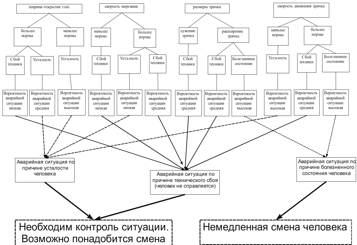
Рис. 1 – Блок-схема анализа поступающих в контролирующие-управляющую систему сигналов биометрической информации о ПС человека-оператора
