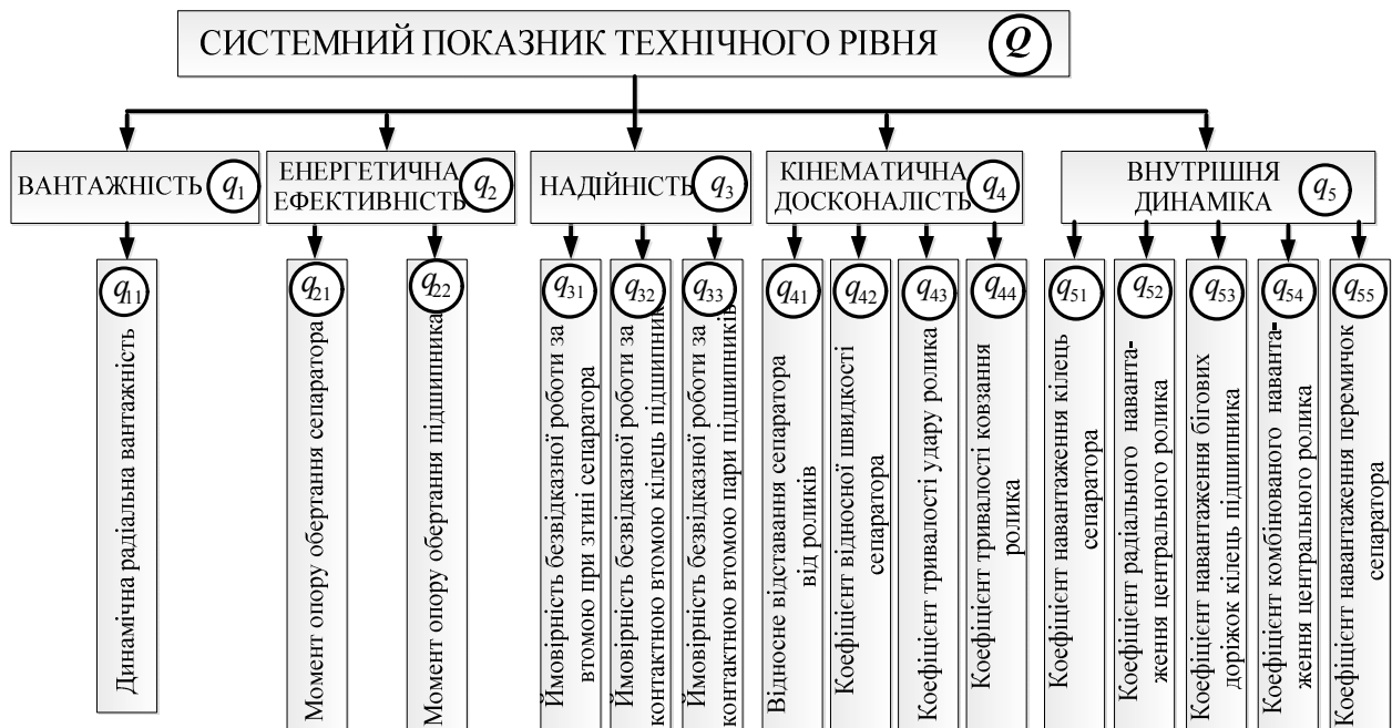
Рис. 2 – Схема системної моделі показника технічного рівня РПБРТ ( q_i, q_{ij} – групові та диференціальні нормовані показники якості, i, j = \overline{1, 5} )
