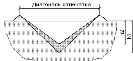
Рис. 5 – Схема отпечатка в разрезе [33]:
