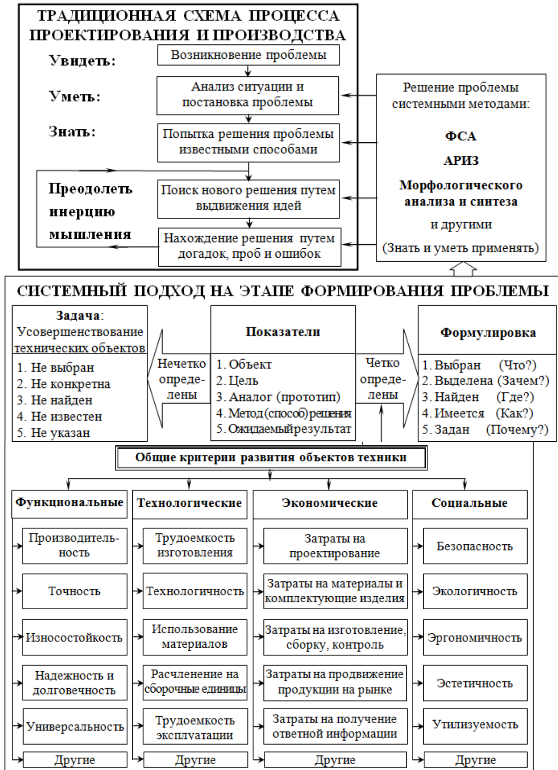
Рис. 5 – Структурная система основных этапов и элементов проектирования в КОРПП
