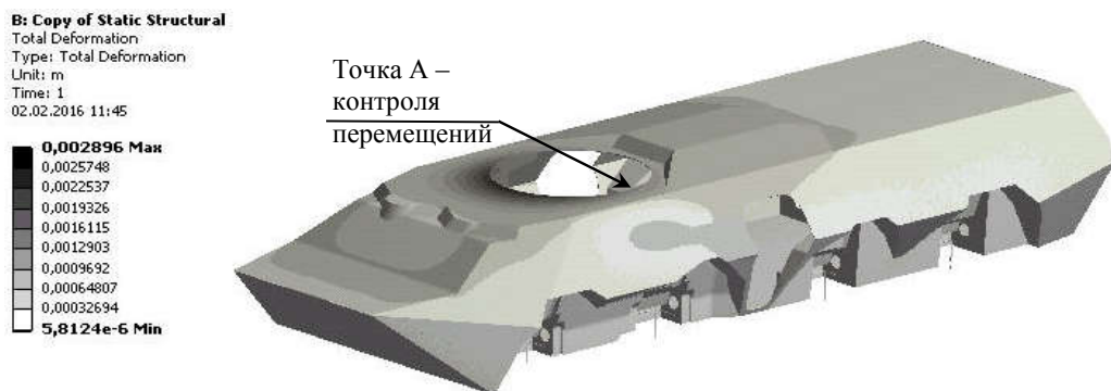
Рис. 1 – Перемещения в корпусе бронетранспортера, м
