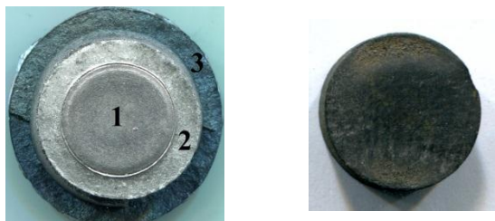
Рис. 2 – Загальний вигляд КВТ після дії високого тиску та температури: (1) зразок в Ta- капсулі, (2) захисна втулка із суміші cBN + CsCl; (3) графітовий нагрівач та отримана керамічна пластина.
