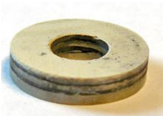
Рис. 2 – Фотография образца слоистого сегнетомагнитного композита
