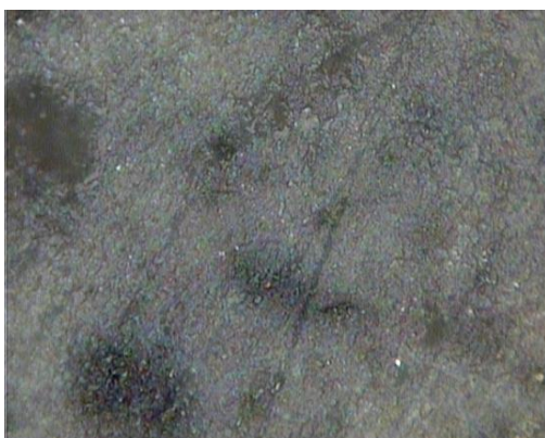
Рис. 3 – Структура горяче-прессованного SiC + Al 2 O 3 (50 % мас.) при температурі 1600 °C, тисненні 30 МПа і часі 4 мин.
