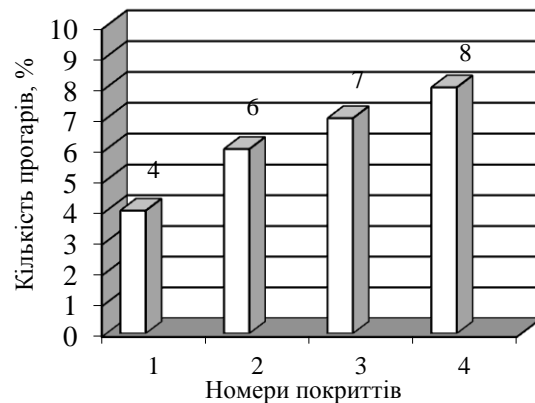
Рис. 2 – Залежність кількості прогарів дослідних покриттів від вмісту у їх складі легкоплавкої емалі № 2 (по табл. 2)
